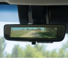
Espejo retrovisor con visión trasera digital
